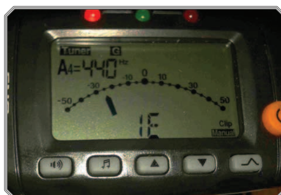
Rys. 11. Wskaźnik dostrojenia. Pozycja strzałki w punkcie właściwego nastrojenia
