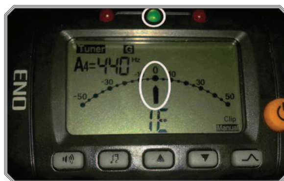
Rys. 11. Wskaźnik dostrojenia. Pozycja strzałki w punkcie właściwego nastrojenia
